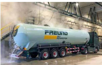
selbst zu bestimmen und den Ablauf anzupassen. Man hat die Wahl zwischen Kalt- und Warmwasser und der Zugabe eines alkalischen Reinigungsmittels. Auf diese Weise können die verschiedenen Produkte so effizient wie möglich gereinigt werden. Nach der Reinigung werden die Tanks getrocknet. Ein Gröninger Drypack erzeugt warme, gefilterte Luft und sorgt für hygienische Ergebnisse innerhalb kurzer Trocknungszeit.
