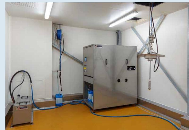
rotierenden Waschkopf zur Reinigung der Innenseite. Die Anlage ist mit unterschiedlichen Waschprogrammen ausgestattet, sodass die Behälter mit verschiedenen Soßen effizient und lebensmittelbeständig gereinigt werden können. So gelten für rote Soßen (z.B. Ketchup oder Curry) andere Spülprogramme als für gelbe Soßen (z.B. Mayonaisen).
